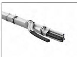
Bandagierung von freihängenden Kabelanlagen
