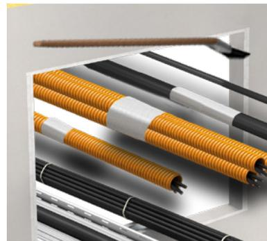
3. Schottmasse so einbringen, dass ein fester, dichter Anschluss zum Bauteil entsteht. Zwischenräume und Zwickel-Hohlräume vollständig ausfüllen.
