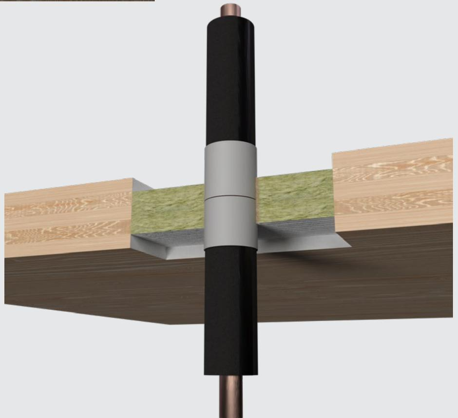
Durchführungen von nichtbrennbaren Rohren mit Brandschutzband bei Wand- und Deckenabschottung
