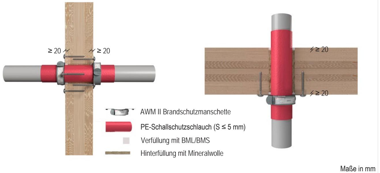
Die Brandschutzmanschette ist mit Holzbauschrauben zu befestigen (Wand beidseitig: Länge 80 mm,  $\text{Ø} \geq 8$  mm. Decke unterseitig: Länge 100 mm,  $\text{Ø} \geq 6$  mm).
