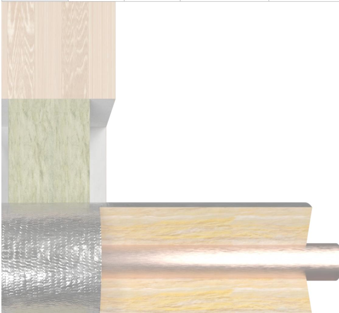
Durchführungen von nichtbrennbaren Rohren mit PIR-Isolierung und Brandschutzband bei Wand- und Deckenabschottung
