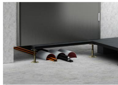
5. Schottmasse gemäß Verpackungsanweisungen anrühren und so einbringen, dass an den Seiten ein fester, dichter Anschluss zum Bauteil entsteht. Oben müssen ca. 2 cm zum Systemboden als Dehnfuge verbleiben.
