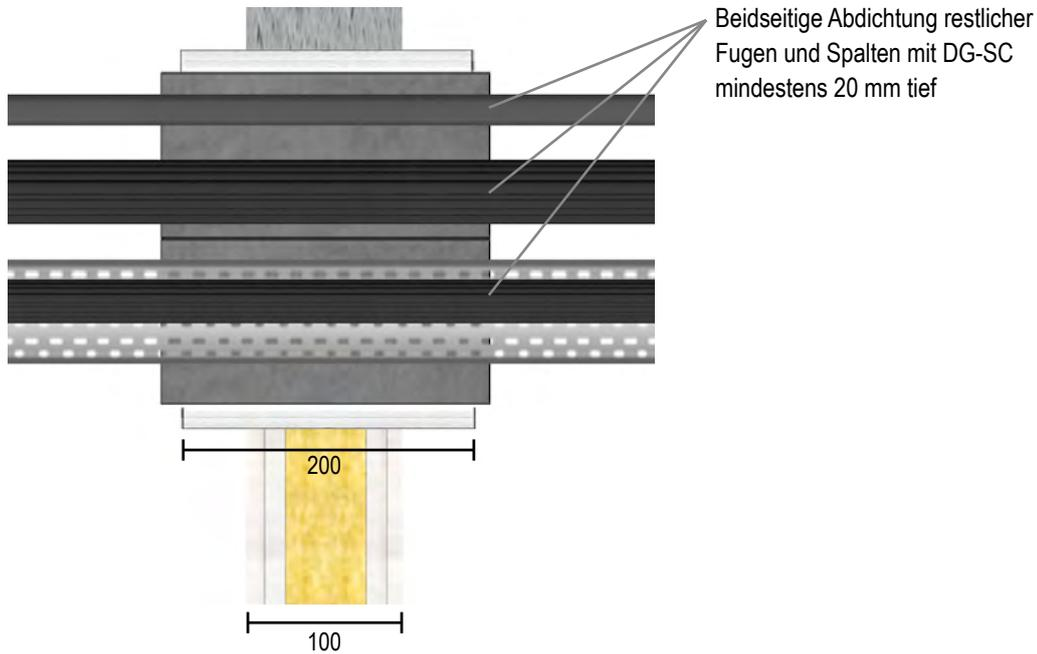
Die Installationen werden senkrecht zur Decke durch die Öffnung geführt. In Decken werden die Brandschutzsteine bündig zur Deckenunterseite eingebaut. In Abhängigkeit von der Bauteilstärke muss deckenoberseitig eine umlaufende Verstärkung aus nichtbrennbaren Bauplatten (z. B. GKF-Platten) erfolgen.
