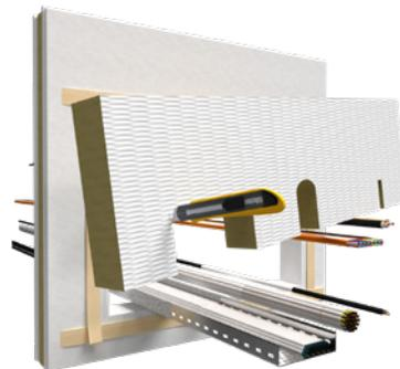
5. Kanten der Mineralfaserplatte mit FLAMMOTECT-A einstreichen und Platte stramm sitzend bündig einbringen
