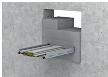
5. Restfugenspalt beidseitig mit DG-SC 20 mm tief verschließen. Schottschild sauber ausfüllen und dauerhaft neben / über (nicht auf!) dem Schott anbringen.
