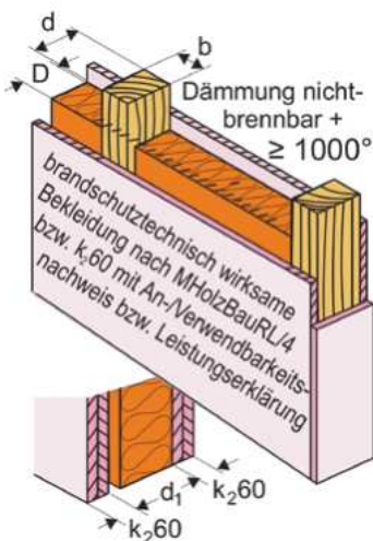
Abb. 3-3: Holzrahmen- und Holztafelbauweise nach MHolzbauRL Abschnitt 4
