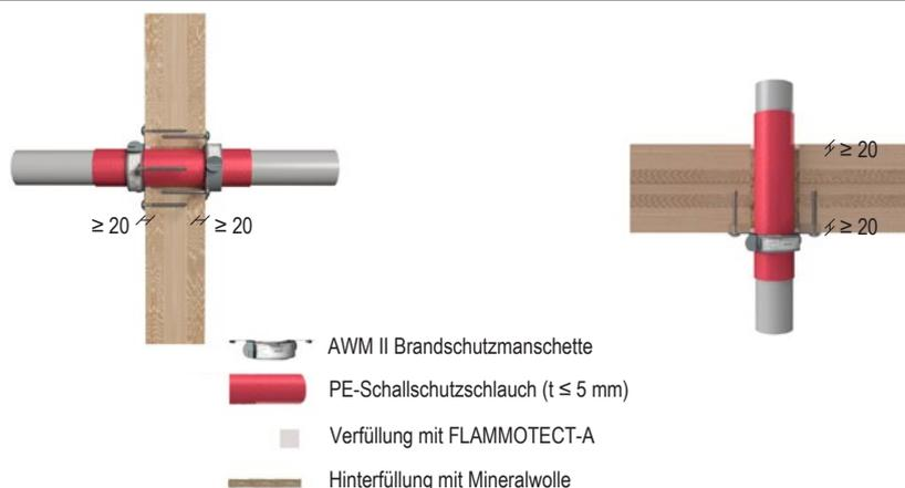
Die Brandschutzmanschette ist mit Holzbauschrauben (Wand beidseitig: Länge 80 mm Wand, Ø ≥ 8 mm. Decke unterseitig: 100 mm, Ø ≥ 6 mm) zu befestigen.
